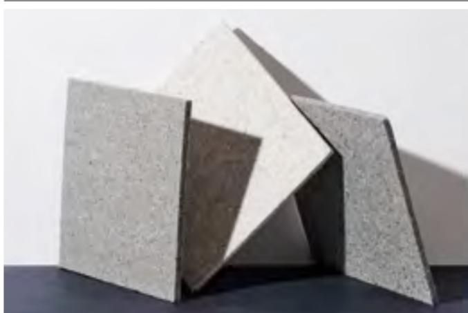
*Solid Textile Board* è un materiale pre-rivestito ad alta densità realizzato con tessuti di scarto di cotone. Ideale per applicazioni orizzontali, soddisfa gli standard più elevati dell'industria del mobile. *Melamine* nell'immagine è un progetto di Anne Boysen.
