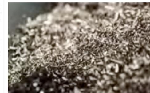
Il 100% del materiale di scarto dell'ottone dell'azienda, derivante dal processo di lavorazione e rettifica, viene rifuso in lingotti di ottone e riciclato per produrre nuovi prodotti.
